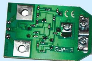
WZMACNIACZ ANTENOWY SWA 2000 DO 130 km
