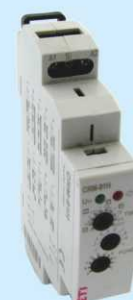
PRZEKAŹNIK CZASOWY CRM-91H ILOŚĆ FUNKCJI 10 ZNAMIONOWE NAPIĘCIE ZASILANIA AC/DC 12-240V 50Hz ZAKRES CZASU 0,1s-10dni
