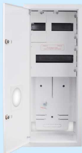
Rozdzielnica wnąkowa RW24 • zaciski zerowe • szyny mocujące TH35 • liczba modułów 23 • tablica licznikowa 3f • wymiary: 775x285x220
