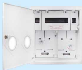
Rozdzielnica wnąkowa RW17 • zaciski zerowe - szyny mocujące • liczba modułów 155 • tablice licznikowe 2 x 1f • wymiary: 460x420x170
