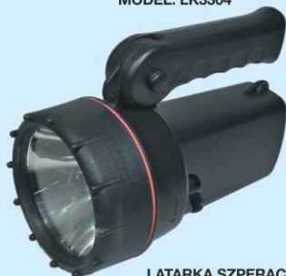
LATARKA SZPERACZ AKUMULATOR 6V, ŁADOWANA Z SIECI 230V, LUB Z SAMOCHODU 12V, ŻARÓWKA H3 6W/25W RUCHOMA REKOJEŚĆ, BRYZGOSZCZELNA, MODEL JML 2999 NS
