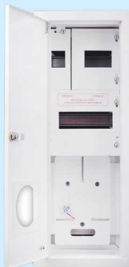
Rozdzielnica wnąkowa RW23 • zaciski zerowe • szyny mocujące TH 35 • tablica licznikowa 1f • liczba modułów 14 • wymiary: 650x210x170
