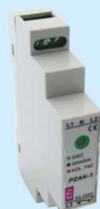
PRZEKAŹNIK ZANIKU FAZY ASYMETRII OBŁĄCZENIA I KOLEJNOŚCI FAZ PZAK-1 NAPIĘCIE 3x400/230V ZACISK ZASILAJĄCY L1, L2, L3 PRÓG ZADZIAŁANIA U min. 175V OBŁĄCZENIE STYKÓW 81
